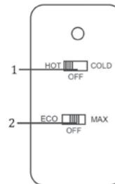
Dacă dorîți să creșteți eficiența energetică și să limitați capacitatea de răcire a unității de răcire, utilizați modul ECO.
