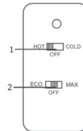
Se si vuole impostare una maggiore efficienza energetica e una limitata capacità di raffreddamento per il raffreddatore, utilizzare la modalità ECO del raffreddatore.
