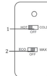
Si vous voulez augmenter l'efficacité énergétique et limiter la capacité de refroidissement de la glacière, utiliser le mode ECO.
