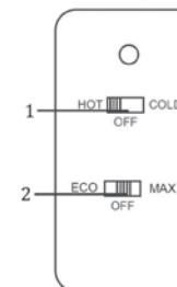
Nutzen Sie für eine erhöhte Energieeffizienz und begrenzen Kühlleistung des Geräts den ECO-Modus des Kühlers.
