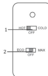
Si desea configurar una eficiencia energética mayor y una capacidad de enfriamiento limitada de la unidad refrigeradora, utilice el modo ECO.
